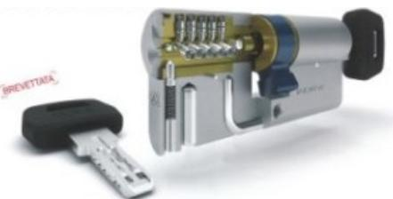
**AGB SCUDO DCK** - Cilindro ad elevata sicurezza: 15 pistoncini radiali e asimmetrici in acciaio inox, barra antistrappo, spine antitrapano, duplicazione della chiave controllata e protetta da codice PIN
