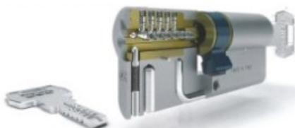
**AGB SCUDO 9000** - Cilindro ad elevata sicurezza: 17 pistoncini in acciaio inox, barra antistrappo e spine antitrapano
