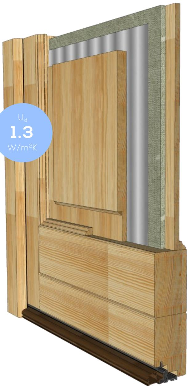
Portone in legno ad alto isolamento energetico e acustico, con anta e telaio in legno lamellare spessore 68mm, pannelli spessore 48mm con isolante e lastra di ferro zincato antisfondamento, doppia guarnizione termoacustica, soglia in alluminio a taglio termico alta 25mm.
