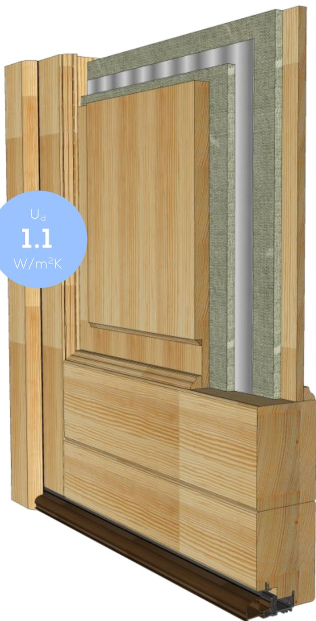
Portone in legno ad alto isolamento energetico e acustico, con anta e telaio in legno lamellare spessore 80mm, pannelli spessore 60mm con isolante e lastra di ferro zincato antisfondamento, tripla guarnizione termoacustica, soglia inferiore in alluminio a taglio termico alta 25mm.
